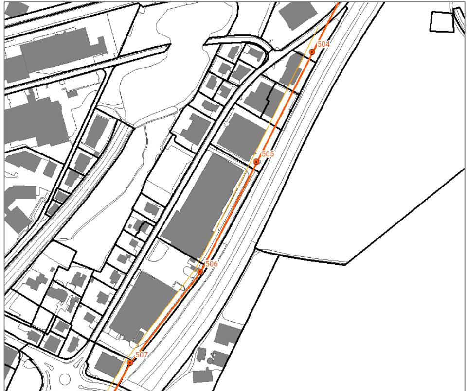
Abb. 4: Leitungsachse und Abstandsbereich
